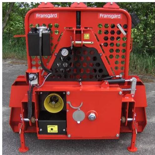
EH Model hat gelenkwellengetriebene Hydraulik zu Bedienung von Kupplung und Bremse via Funk- oder Kabelsteuerung.
