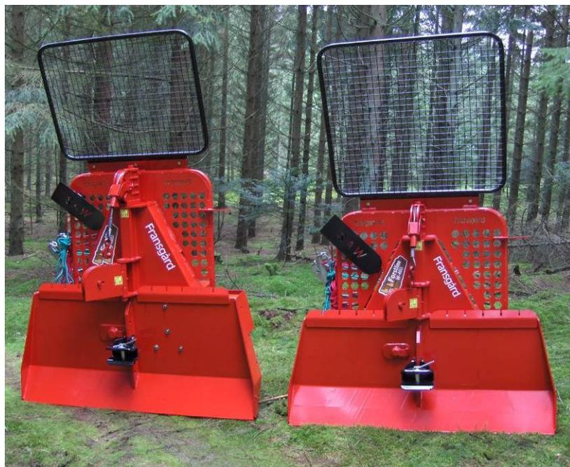
Das einzigartige Design der Winde ist bis ins Detail durchdacht. Robuste Konstruktion mittels hochfesten Stahls, breites solides Schild und unterer Seileinlauf und Halter für Axt ist bei allen Modellen serienmäßig, die Halterung für Motorsägen und die Anhängerkupplung sind auf Wunsch verfügbar.
